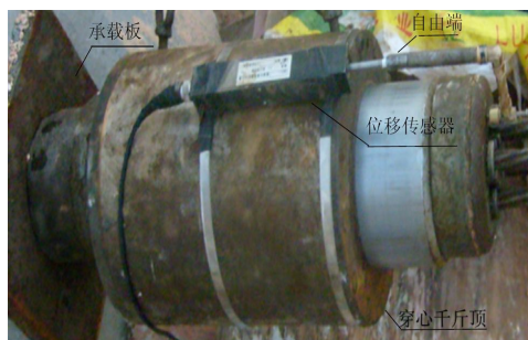
图1 位移传感器安装示意图
