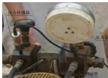
图2 压力传感器安装示意图
